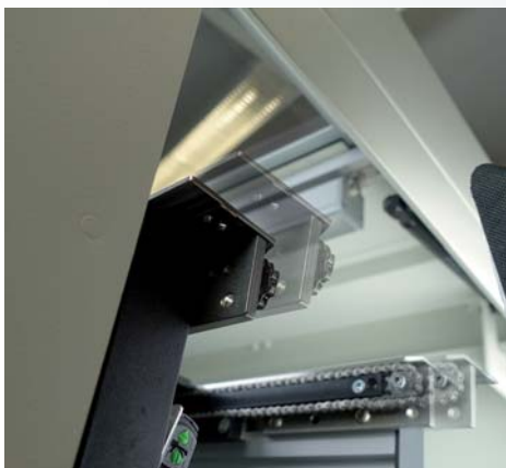
Zur optimalen Einpassung am Ein- und Auslauf sind die Längen der Transportschienen adaptierbar
